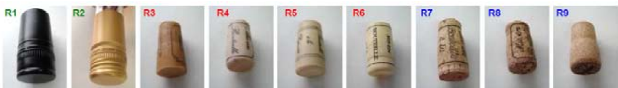
2 types de capsule, 4 bouchons synthétiques et 3 bouchons en liège ont été testés au cours de cette étude
